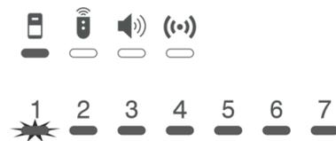
Die freien Zonen (noch keine Detektoren registriert) leuchten grün. Zonen, in denen bereits Detektoren hinterlegt wurden, leuchten rot. Die aktuell ausgewählte Zonennummer blinkt.
