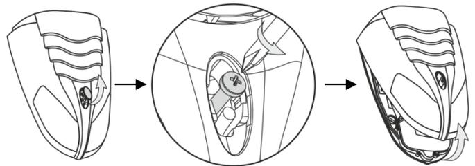
2. Entfernen Sie die Lichtleitung. Lösen Sie die Schrauben und entfernen Sie die Metall- und Plastikabdeckungen. Schützen Sie die Batterie, sowie die elektronischen Teile.
