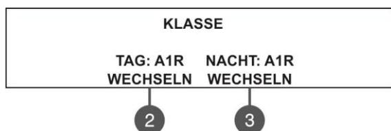
**(1) KLASSE** – Bei Auswahl dieser Taste wird ein weiteres Fenster zur Einstellung der Temperaturklasse im Tag- und Nachtmodus geöffnet. Über die Funktionstasten (2) und (3) wird die Klasse auf das gewünschte Niveau eingestellt. Es wird zwischen folgenden Klassen unterschieden: A1R/ A2S/ BS. Die eingestellte Klasse wird über die Taste ENTER bestätigt.
