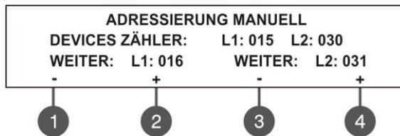
Im Menü für Selbstadressierung finden Sie Information über die gesamte Anzahl der an jeden Loop angeschlossenen Devices. In der dritten Zeile auf dem Bildschirm wird die erste freie Adresse für jeden Loop angegeben. Das Zentrale wird alle schon besetzten Adressen überspringen und nur die freien anzeigen. Der Installateur hat zusätzlich die Möglichkeit, die Adresse über die Funktionstasten 1 bis 4 manuell einzustellen. Mit dem Zeichen – wird
