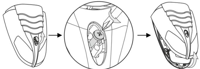
2. Entfernen Sie den Lichtleiter. Lösen Sie die Schrauben und entfernen Sie die Metall- und Plastikabdeckungen. Schützen Sie die Batterie und die elektronischen Teile.
