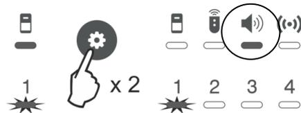
Die BRAVO Zentrale unterstützt den Betrieb einer Außensirene, welche auf die Position 1 registriert werden kann.
