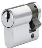
Beim Einbau eines PHZ muss die Schließnase in 30 Grad Abstufungen eingestellt werden, mit Blickrichtung auf den Einsteckschlitz für den Schlüssel. Hierbei muss die Schließnase auf **9 Uhr –links** sein.
